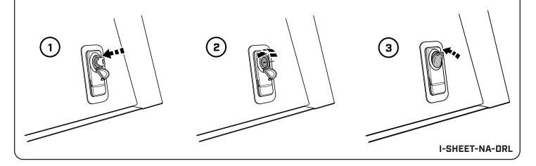
TO UTILIZE THE INTERNAL LATCH RELEASE, SIMPLY PRESS THE RED BUTTON AND THE LATCH WILL OPEN REGARDLESS OF WHETHER IT IS EXTERNALLY LOCKED.
