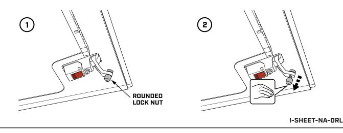
ADJUST THE PLUNGER TO THE HEIGHT AND LENGTH YOU NEED. THEN, USING YOUR FINGERS, TIGHTEN THE ROUNDED LOCK NUT AS FIRMLY AS YOU CAN.
