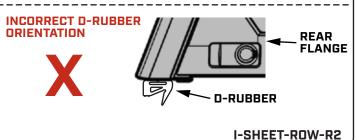
ALIGN THE D-RUBBER ALONG THE SMARTCAP'S EDGE, MAINTAINING A CONSISTENT 1/8 INCH GAP FROM THE EDGE.
